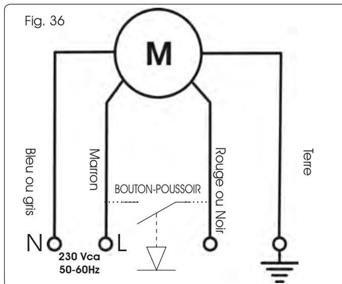
**AUTOMATISME UNIQUEMENT COMMANDÉ À PARTIR D'UNE TÉLÉCOMMANDE:** Si l'on souhaite réaliser ce type de configuration, connecter le fil bleu et le fil marron du moteur au secteur et le fil jaune-vert à la terre. **Le fil ROUGE ou NOIR ne doit pas être connecté.**
