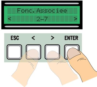
4) .... il vous sera demandé d'introduire un code. Envoyez le code avec la touche de la radio commande ou avec la carte à bande magnétique ou à transpondeur.
