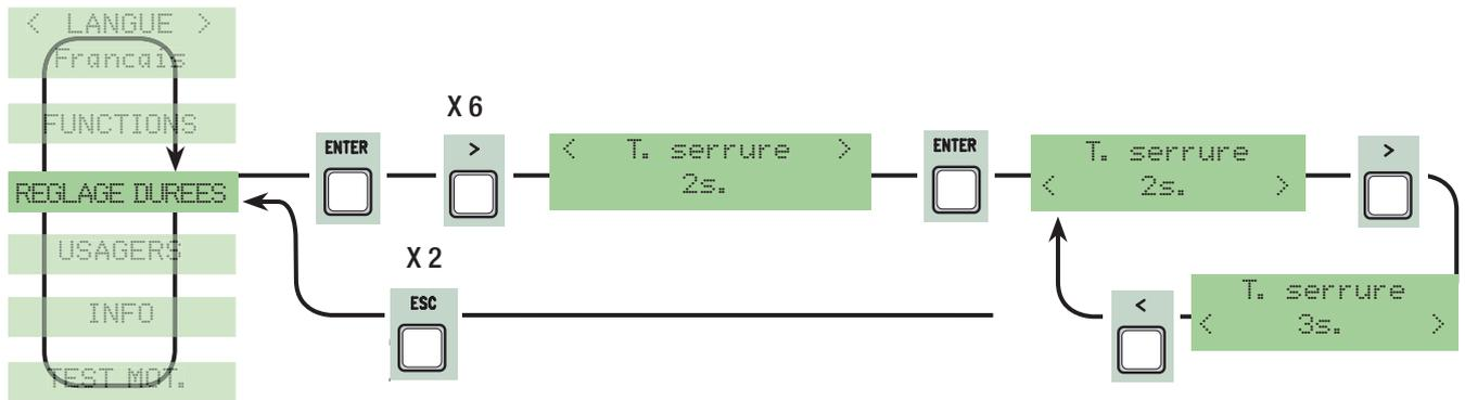
**Durée coup de bélier :** le temps de poussée des motoréducteurs en butée de fermeture après chaque commande d'ouverture. La durée de la poussée peut être réglée de 1" à 10".
