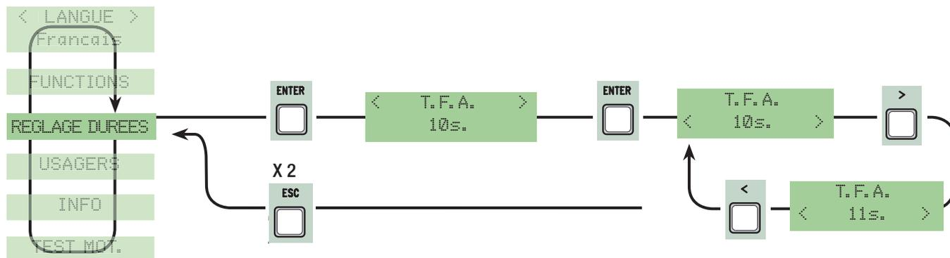
**Fermeture Automatique Piétons :** durée d'attente du deuxième vantail (M2) en position d'ouverture. Lorsque ce temps s'est écoulé, une manœuvre de fermeture s'effectue automatiquement. La durée du temps d'attente peut-être réglée de 0" à 300".
