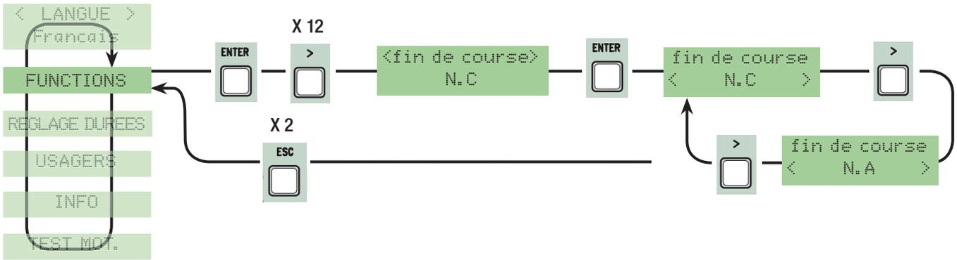
**Commande 2-7 :** configuration du contact sur 2-7 en passe-passe (ouvre-ferme) ou séquentiel (ouvre-stop-ferme-stop).
