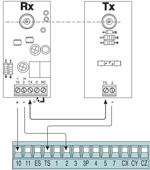
A chaque commande d'ouverture ou de fermeture, la carte contrôle le fonctionnement des photocellules. Une anomalie éventuelle détectée sur les photocellules est signalée par le clignotement de la Led sur la carte électronique et elle annule toute commande de l'émetteur radio ou du bouton.
