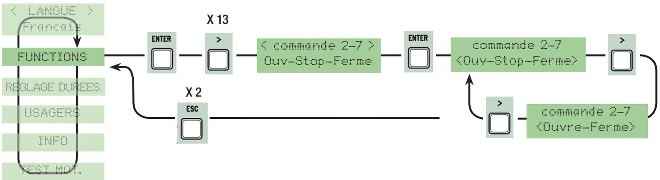
**Commande 2-3P :** configuration du contact sur 2-3P en ouverture piétons (ouverture totale du deuxième vantail) ou partielle (ouverture partielle du deuxième vantail selon la durée de temps configurée sur "Ouverture partielle" dans le menu "Réglage Durée de temps").
