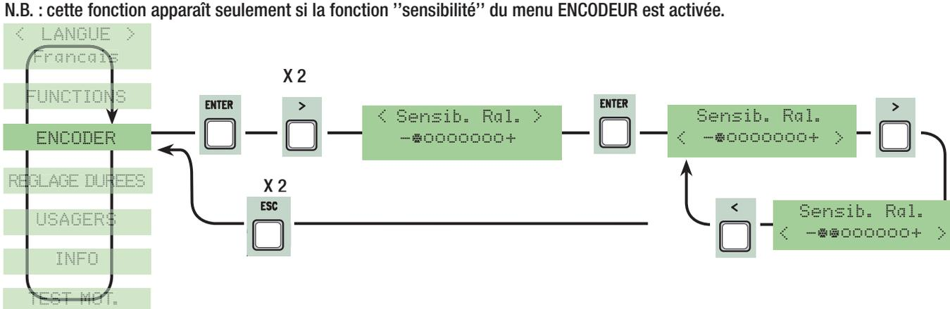
**Ralentissement Encodeur** : il active les points de départ du ralentissement en ouverture et en fermeture.
