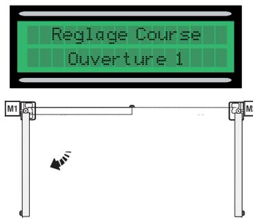
7) Au terme de cette procédure, l'indication "Réglage course OK" apparaîtra pendant quelques secondes sur l'afficheur.
