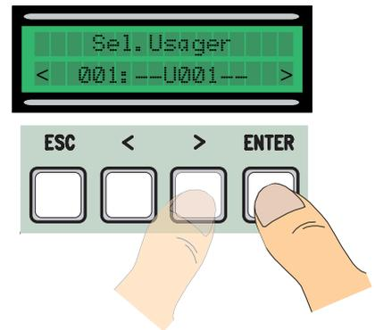
3) Utilisez la touche ENTER pour déplacer le curseur en avant, ESC pour déplacer le curseur en arrière et < et > pour sélectionner la lettre ou le chiffre.
