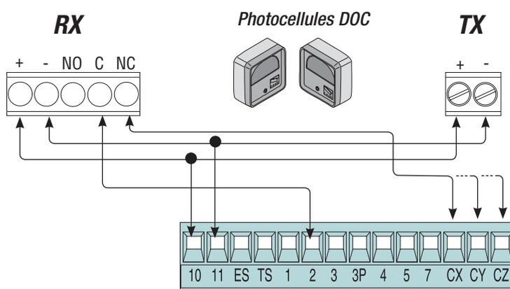
Configurez le contact CX,CY ou CZ (N.C.), entrée pour dispositifs de sécurité type *bords sensibles*, conformes aux normes EN 12978. Voir fonctions d'entrée, CX,CY ou CZ en:
