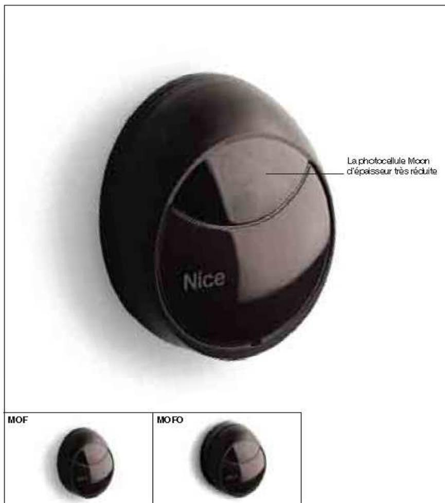
**Photocellules synchronisées avec angle de réception de 10° (MOF), également en version orientable de 30° dans toutes les directions (MOFO).**
