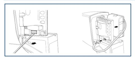
La batterie de secours PS124 viens se loger, dans le coffret derrière la logique de commande
