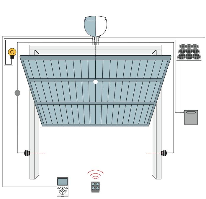
1. Spinbus 2. Emetteur 3. Photocellules 4. Lampe clignotante 5. Sélecteur à clé ou à code
