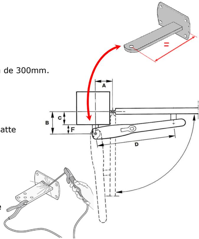
La longueur de la patte de rotation du vérin est représentée par **F**, elle doit être supérieure à 60mm
