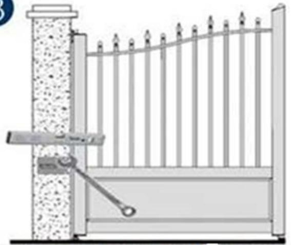
Mettre de niveau le support de vérin et bloquer l'écrou du goujon. Réaliser ensuite les 3 autres trous et placer les fixations
