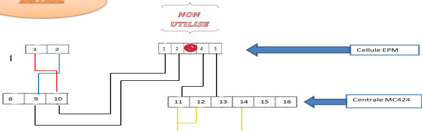
Une fois les connexions raccordées, mettez sous tension, les leds L1 à L5 , P1-P2-P3,vont clignoter 5 secondes, ensuite L1-L2-L3, doivent être allumées fixe.
