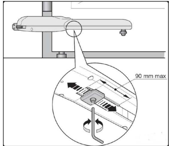
Une fois le motoréducteur posé sur ces axes de rotation, vous pouvez régler la butée de fin de course ouverture, en la déplaçant sur le carter. A l'aide des clés fournies dans le kit, déverrouillez le motoréducteur, et amener manuellement le portail jusqu'à son ouverture désirée.
