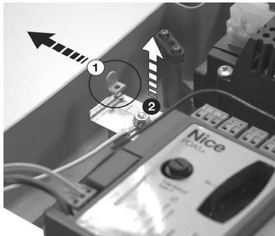
Introduisez la batterie PS 124 derrière La logique de commande
