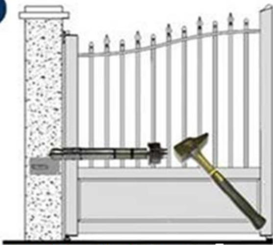
engager le 1er goujon d'ancrage et l'enfoncer au marteau jusqu'à la garde
