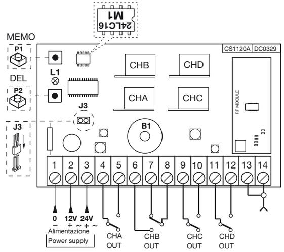
**RICEVITORE A SCHEDA AD INNESTO DIRETTO SLOT-IN RECEIVER CARD RÉCEPTEUR À CARTE EMBROCHABLE STECKEMPFÄNGER RECEPTOR CON TARJETA DE INSERCIÓN DIRECTA**
