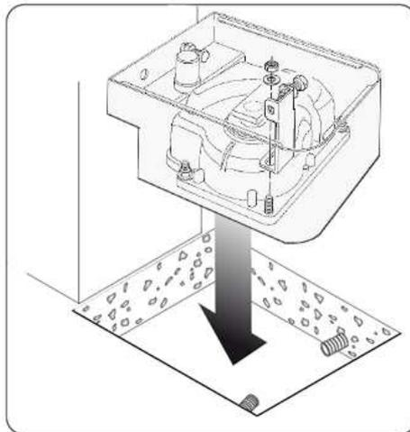
Pour la mise en place des caissons de fondation, réaliser une fouille de 350x450x200mm.
