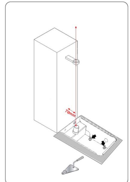
La mise en place du bras d'entraînement du portail peut être réalisée soit par point de soudure, soit à l'aide de vis.
