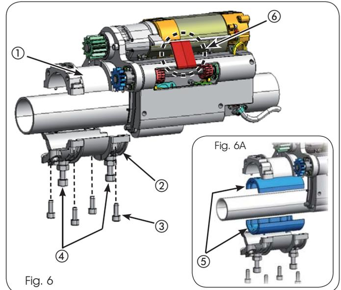
**⚠ Au cours des opérations d'installation, faire particulièrement attention à NE PAS DÉMONTÉ la bride de service réf. ⑥ Fig. 6 pour ne pas compromettre la position initiale des fins de course.**
