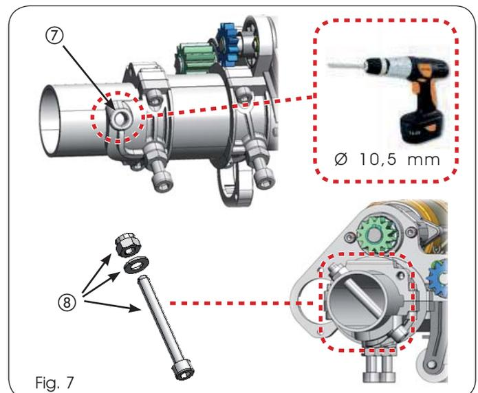
5. En prenant comme référence le trou sur la bride Fig. 7 réf. ⑦, réaliser un trou passant (Ø 10,5 mm) sur l'arbre d'enroulement;
