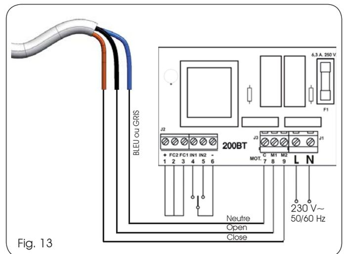
Sur les applications R180 et R280, les fins de course sont intégrés; il faut donc court-circuiter les connexions dédiées sur la platine 200BT.
