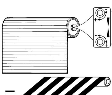
= Sens de rotation de la vis de réglage si le volet (ou la toile) s'arrête avant la position d'arrêt basse
