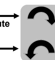
Sens de rotation de la vis de réglage si le volet (ou la toile) s'arrête avant la position d'arrêt haute
