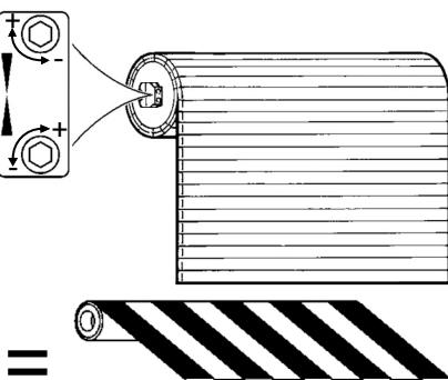
Sens de rotation de la vis de réglage si le volet (ou la toile) descend trop bas
