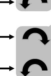
Sens de rotation de la vis de réglage si le volet s'arrête avant la position d'arrêt basse
