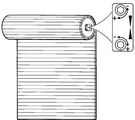
= Sens de rotation de la vis de réglage si le volet s'arrête avant la position d'arrêt haute
