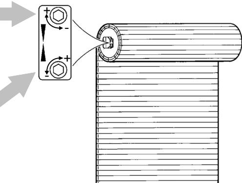
Sens de rotation de la vis de réglage si le volet monte trop haut
