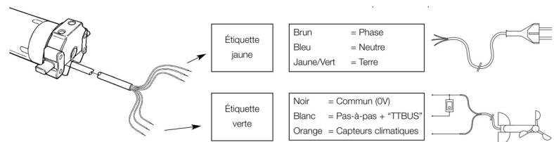
**Avant d'effectuer la première programmation d'un moteur par la radiocommande, il est préférable de couper l'alimentation des moteurs ou logiques Nice environnants non encore programmés.**
