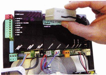
Insérer le récepteur sur le connecteur 3 broches
