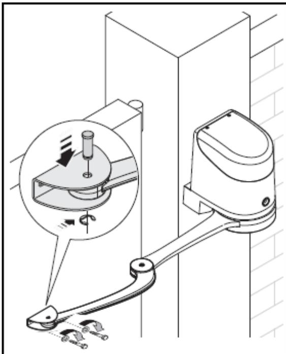
Avec la clé déverrouiller le moteur, et déployer le bras articulé au maximum contre le portail.
