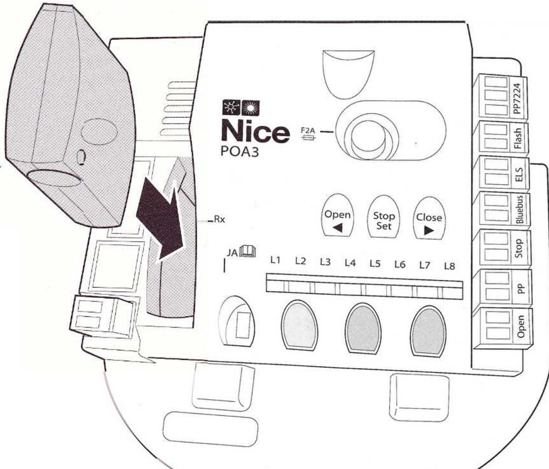
Une fois les connexions raccordées, mettez sous tension, les leds L1 et L2 vont clignoter lentement, et le témoin Blue-Bus doit clignoter à chaque seconde.
