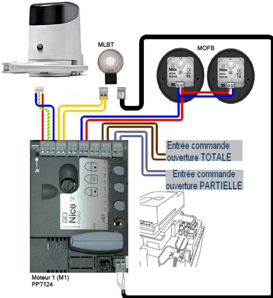
Sur les entrées de commande "ouverture partielle et totale", peuvent être raccordées en parallèle, les commandes d'interphone, de visiophone, de contact à clé, de bouton poussoir, ou tout autre commande sans polarité
