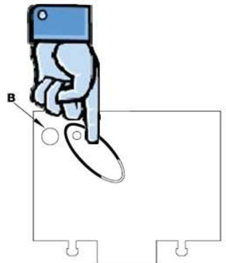
led radio va émettre 3 clignotements longs pour valider l'enregistrement.
