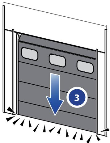
Après 8 secondes, l'actionneur se ferme automatiquement jusqu'à ce qu'il détecte la butée.
