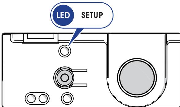
Si la procédure d'apprentissage s'est terminée positivement la LED SETUP arrête de clignoter, elle reste allumée 5 secondes puis elle s'éteint.
