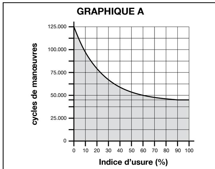
**Exemple du calcul de durabilité d'un motoréducteur Wingo WG5024 (voir Tableau 2 et Graphique A):**
