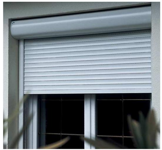
Le moteur utilisé d'un couple de 30Nm peut manœuvrer un volet roulant en PVC ou aluminium d'une surface maxi de 9m<sup>2</sup> avec le tube d'enroulement ZF54.
