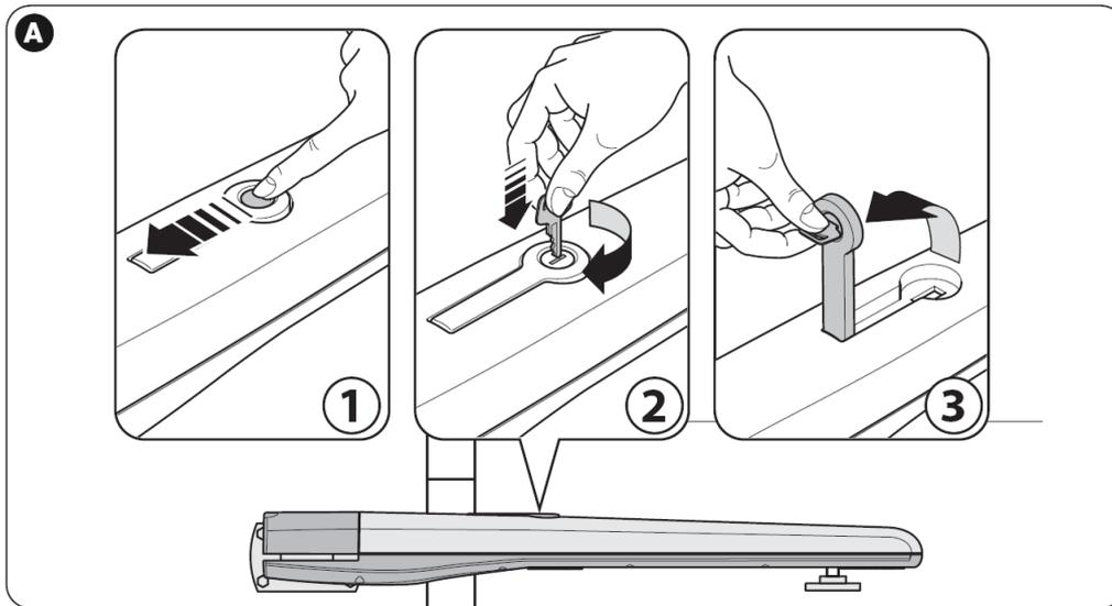
Une fois le motoréducteur posé sur ces axes de rotation, vous pouvez régler la butée de fin de course ouverture, en la déplaçant sur le carter. Déverrouillez le motoréducteur, et amener manuellement le portail jusqu'à son ouverture désirée.
