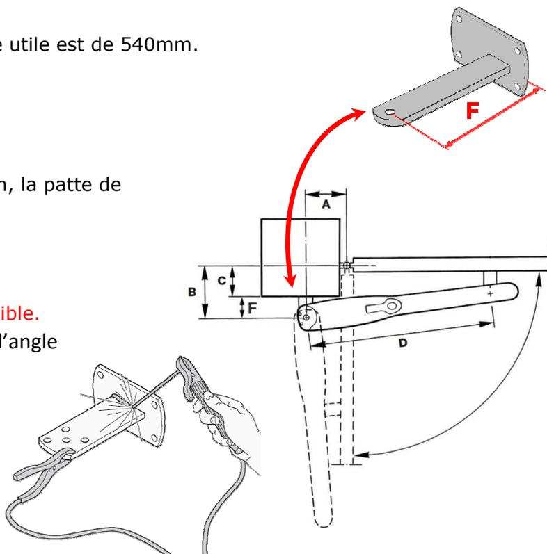
La longueur de la patte de rotation du vérin est représentée par **F**, elle doit être supérieure à 60mm
