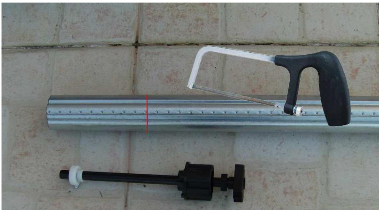
Retirer le tandem réglable du tube d'enroulement et recouper à la dimension souhaitée
