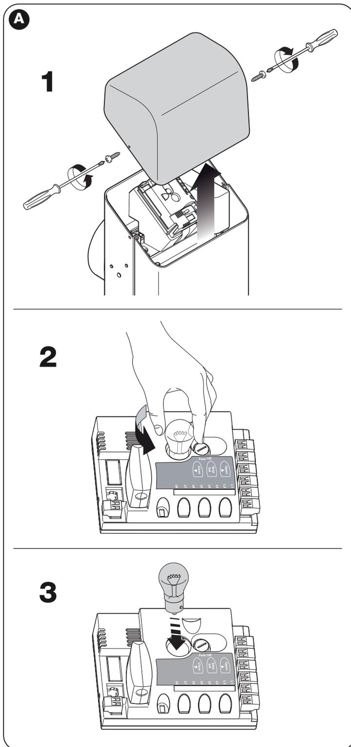
placer la lampe présente sur la logique de commande, il est important, avant tout, de déconnecter X-Bar de n'importe quelle source d'alimentation électrique (y compris la batterie tampon) et de procéder comme indiqué **fig. A** ; remplacer l'ampoule grillée par une autre possédant les mêmes caractéristiques (12 V / 10 W – culot BA15S).
