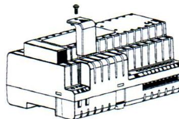
Cache du bornier secteur dans le cas d'un montage hors armoire électrique normalisé.
