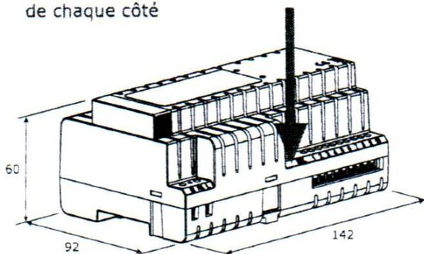
Protégée par fusibles réarmables en entrée et en sortie. (Après une surcharge ou un C.C pour réarmer le fusible débrancher le réseau pendant 1 mn).
