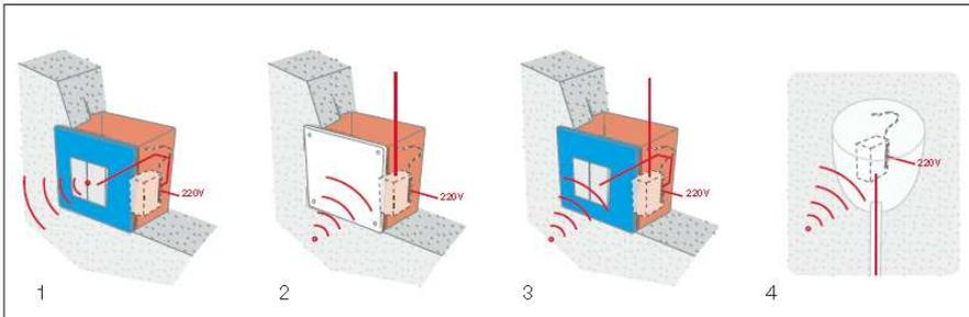
1. TTX4: émetteur encastrable avec alimentation secteur. Idéal pour la commande d'automatismes qui ne sont pas directement accessibles par commandes filaires.
