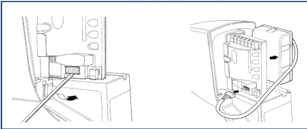
La batterie de secours PS124 viens se loger, dans le coffret derrière la logique de commande
