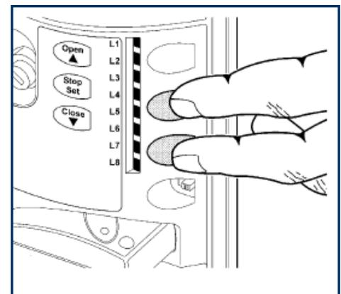
Si la première manœuvre a) n'est pas une ouverture, stopper la procédure de reconnaissance en appuyant sur STOP. Inverser le commutateur de direction, recommencer la procédure 4).
