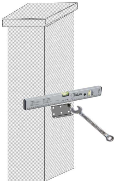
Présenter le support d'automatisme, et le bloquer de niveau, avec une clé de 17
