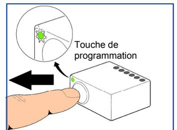
Insérer les piles dans l'accessoire à enregistrer (ou appuyer une fois sur la touche [ T ] si elles y sont déjà présentes). L'interface va émettre un bip, les leds A et B vont clignoter pour confirmer son enregistrement.
