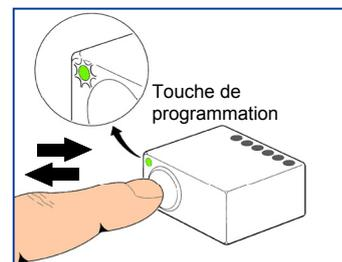
Appuyer brièvement sur la touche de programmation de l'interface qui va émettre des bips pendant 1 minute. Durant ce laps de temps il faudra effectuer la phase de reconnaissance des dispositifs en maintenant enfoncées les touches [ ▲ ] et [ SET ] de la logique de commande.
