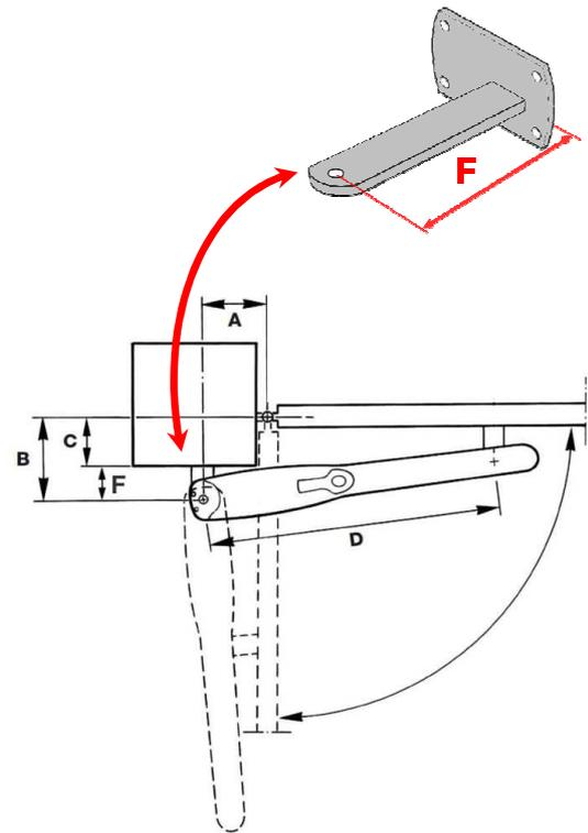
La longueur de la patte de rotation du vérin est représentée par **F**, elle doit être supérieure à 60mm
