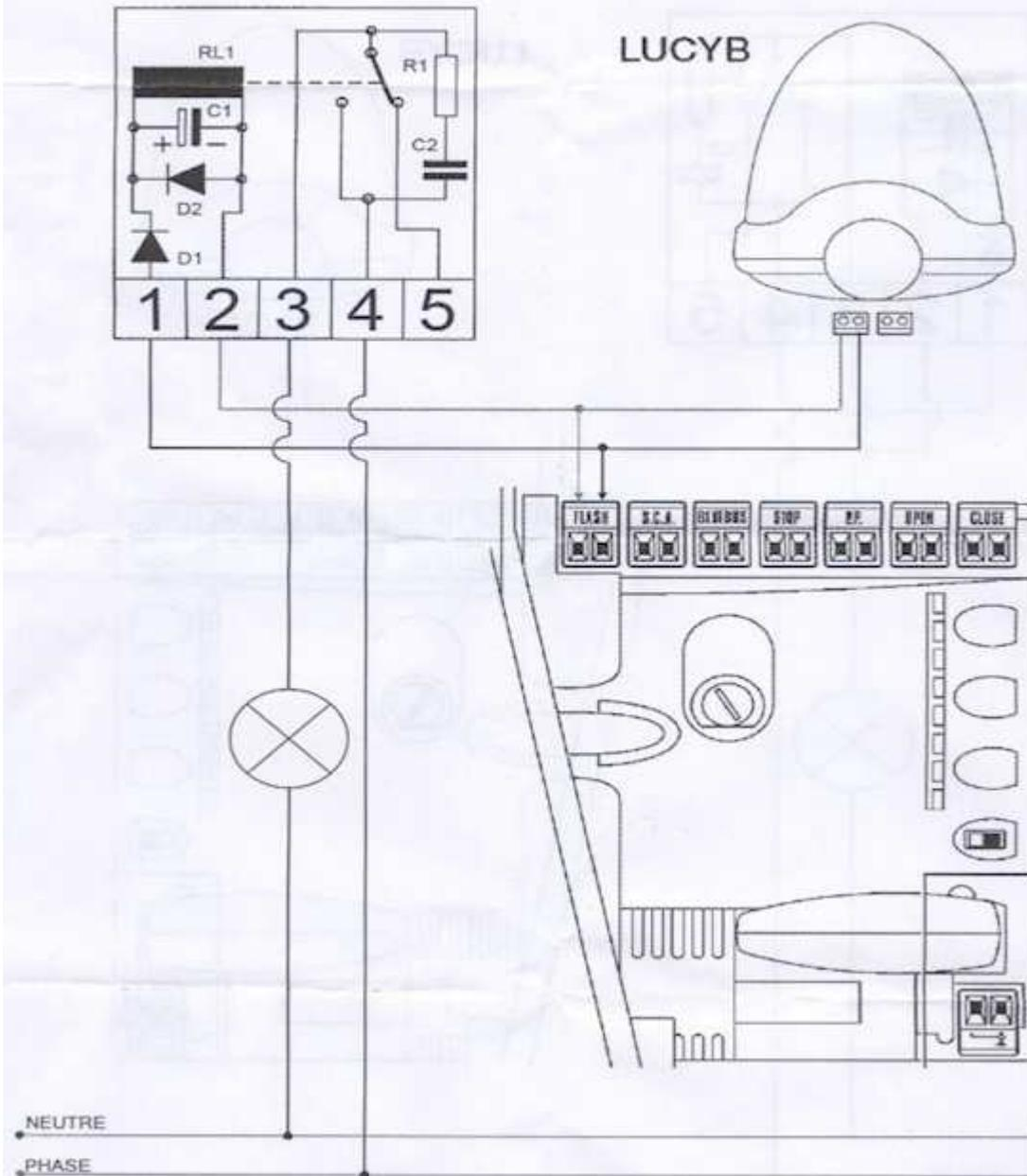
Câblage du relais pour éclairage de zone. Puissance Maxi 660 watts
