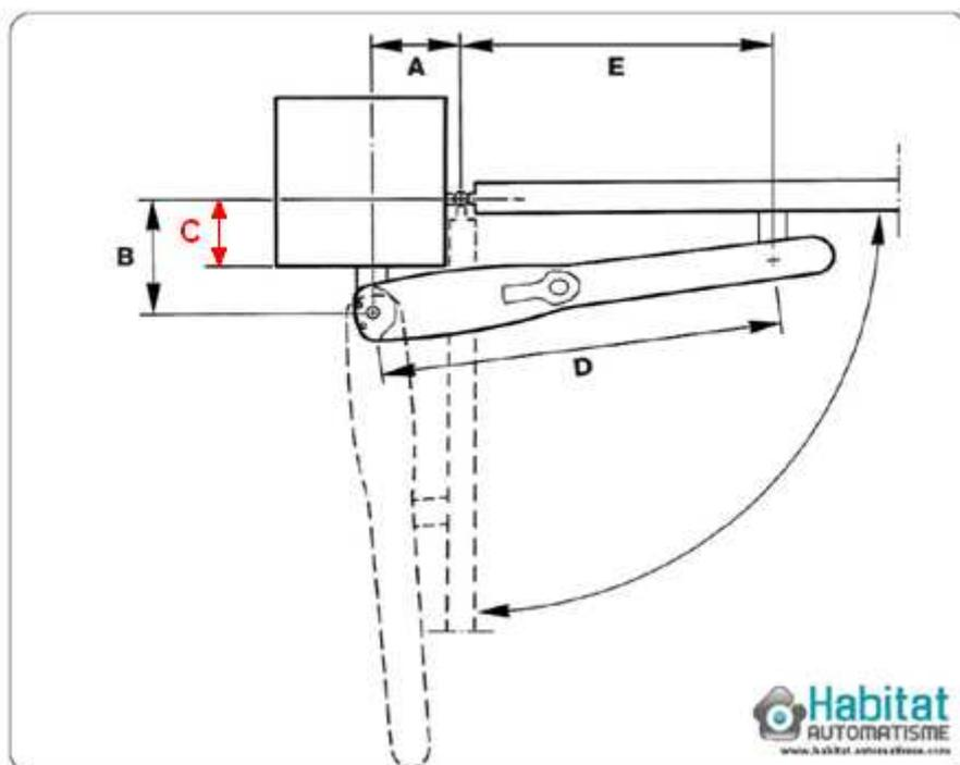
La cote C doit être inférieure ou égale à 90mm pour que l'installation du WingoKit 4024, soit possible, dans le cas d'une installation d'un portail posé entre piliers
