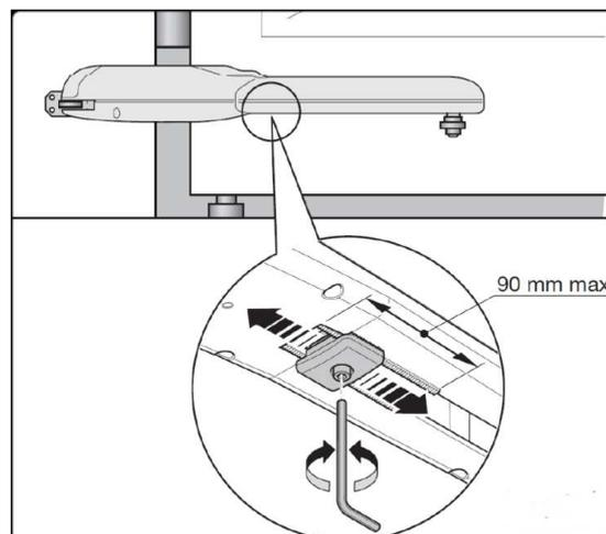
Une fois le motoréducteur posé sur ces axes de rotation, vous pouvez régler la butée de fin de course ouverture, en la déplaçant sur le carter.
