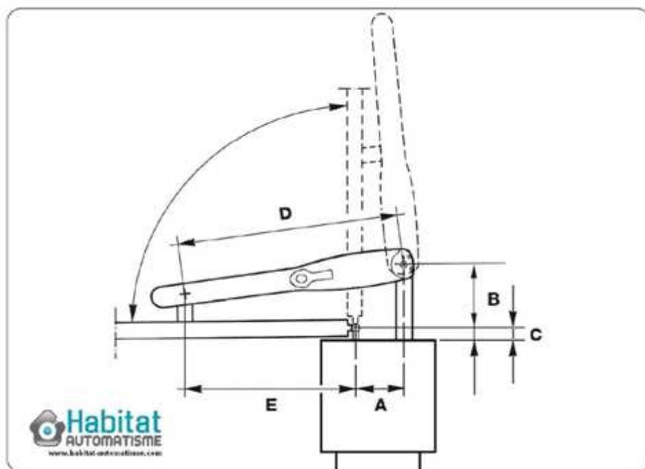
La cote C ne présente aucune contrainte dans le cas de portail posé à l'arrière des piliers.
