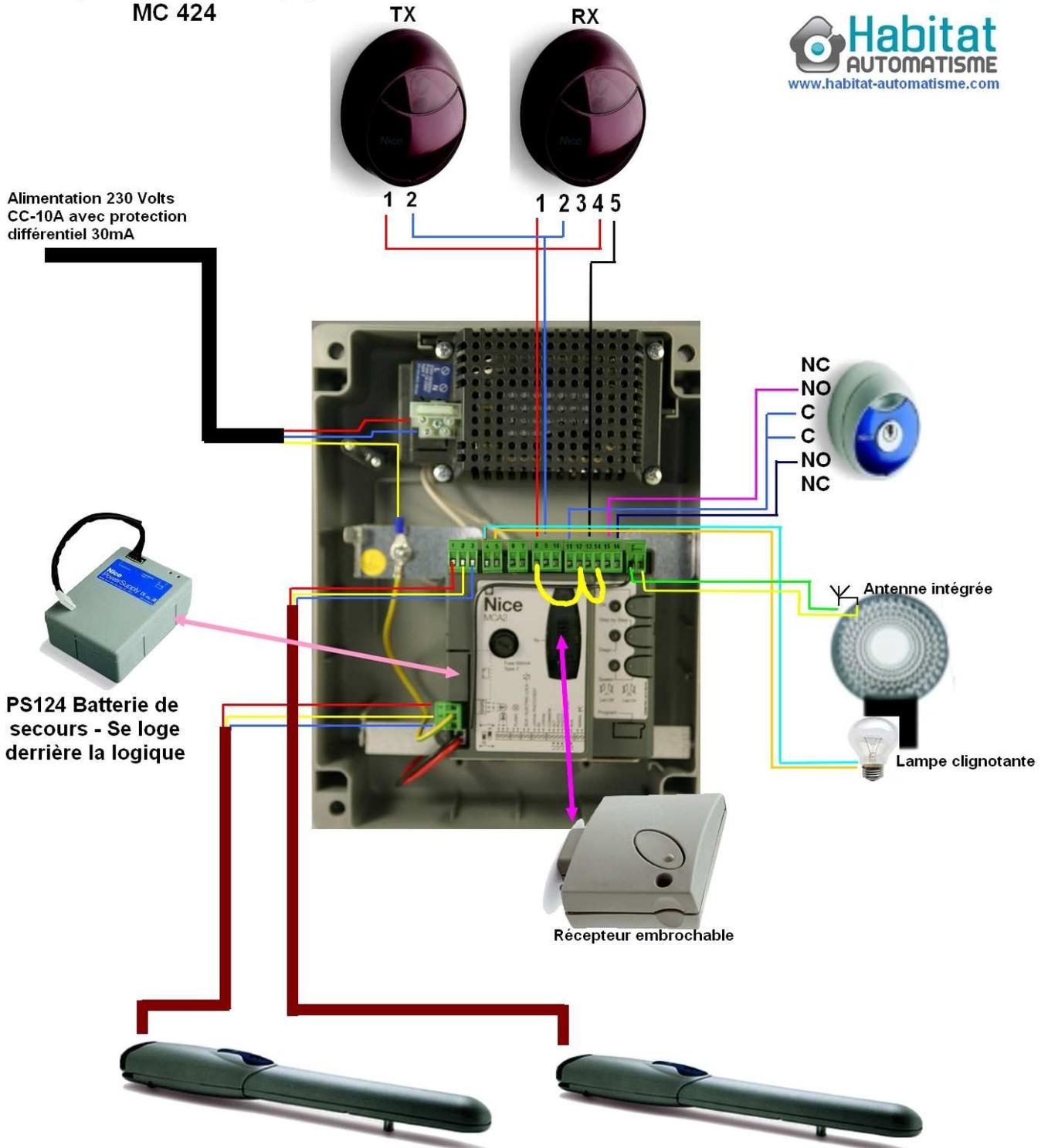
Une fois les connexions raccordées, mettez sous tension, les leds L1 à L5, P1-P2-P3, vont clignoter 5 secondes, ensuite L1-L2-L3, doivent être allumées fixe.
