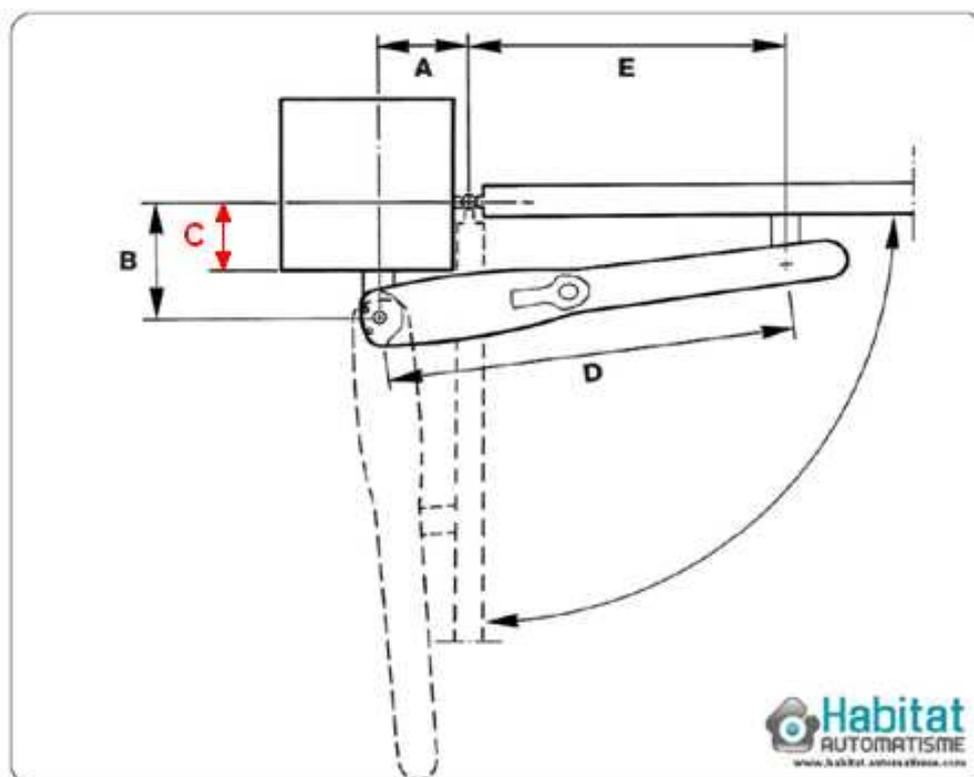
La cote C doit être inférieure ou égale à 250mm pour que l'installation du WingoKit 5024, soit possible, dans le cas d'une installation d'un portail posé entre piliers
