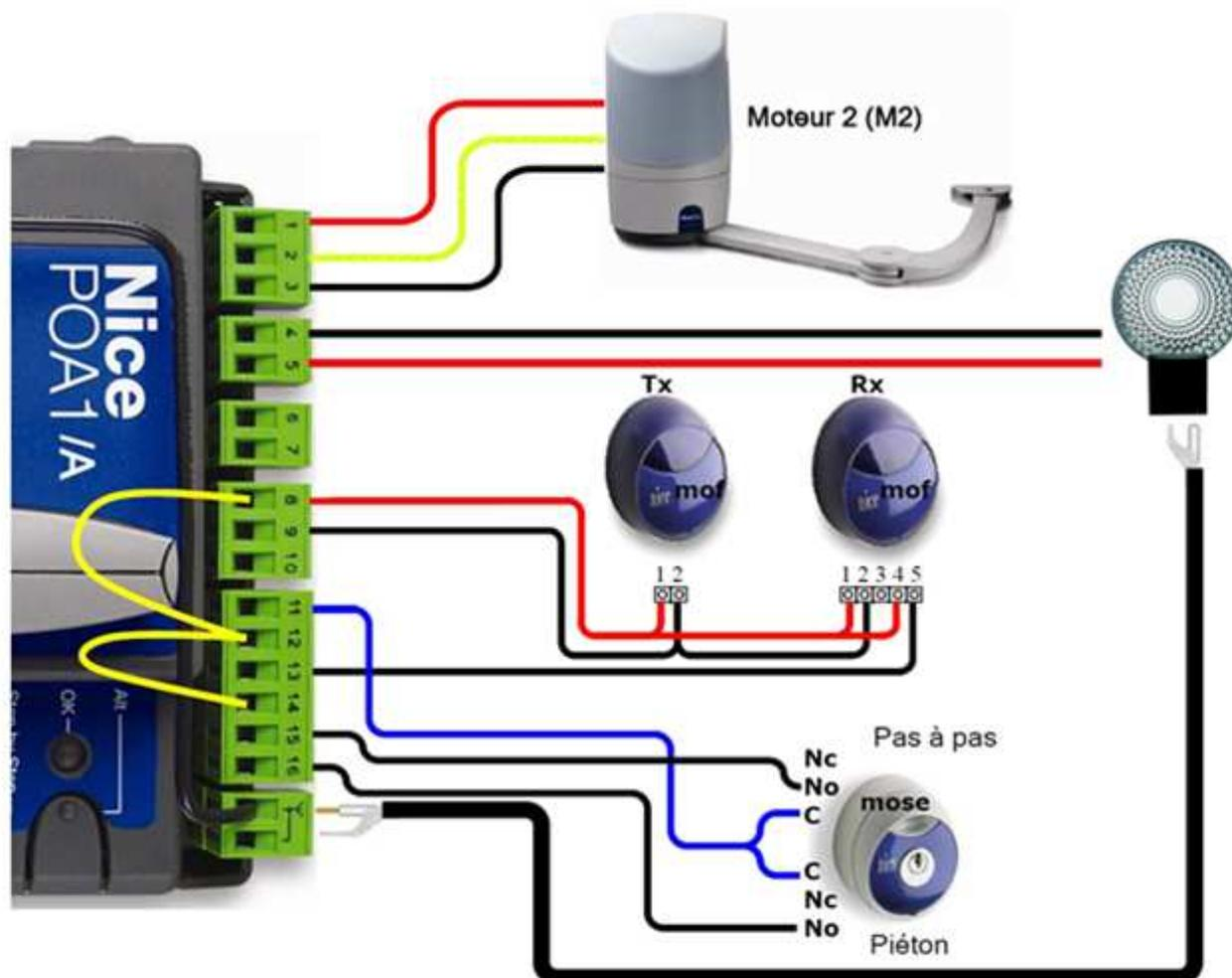
Une fois les connexions raccordées, mettez sous tension, les leds L1 à L5, P1-P2-P3, vont clignoter 5 secondes, ensuite L1-L2-L3, doivent être allumées fixe.
