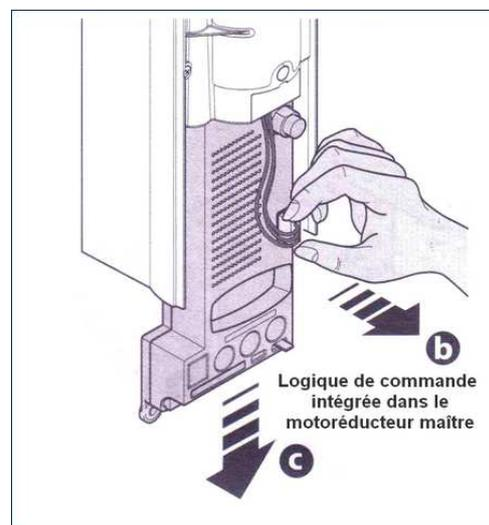
Passer le câble d'alimentation électrique dans le logement prévu à cet effet
