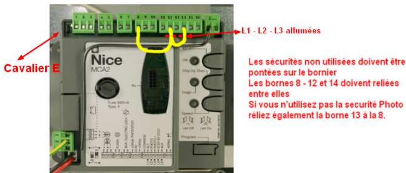
Les sécurités non utilisées doivent être pontées sur le bornier
