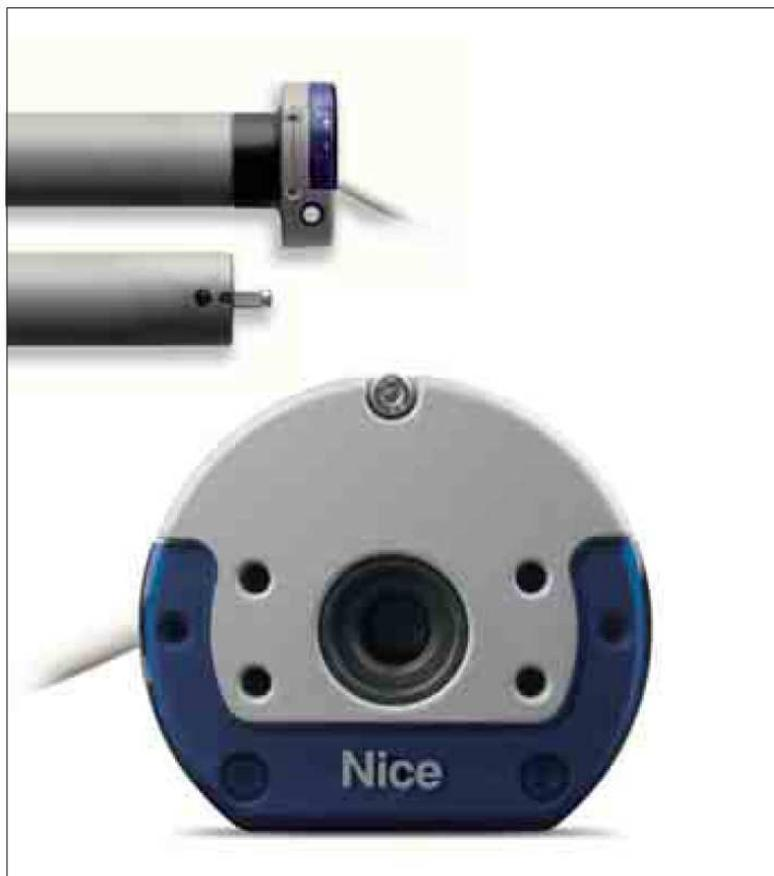
**Moteur tubulaire idéal pour stores, volets roulants ou portes de garage à enroulement avec manœuvre de secours manuelle et fin de course mécanique, logique de commande et récepteur intégrés.**
