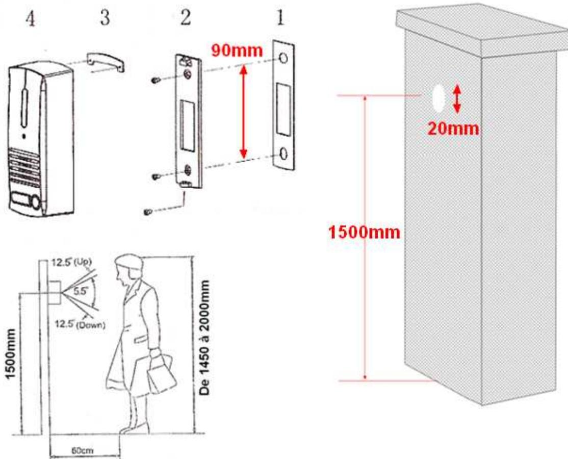
Réaliser un perçage du pilier au diamètre 20mm, nécessaire au passage des câbles
