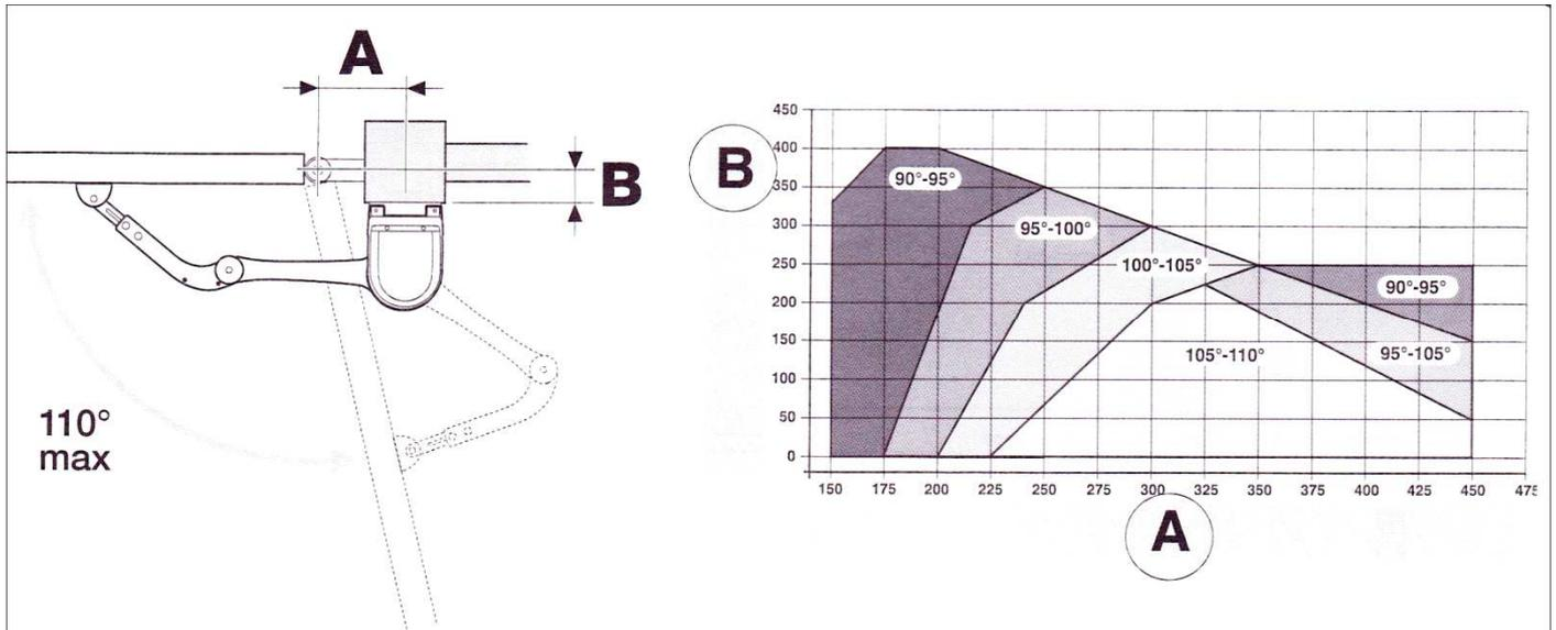
L'angle d'ouverture est fonction de la cote de décalage A, et de la cote de retrait B
