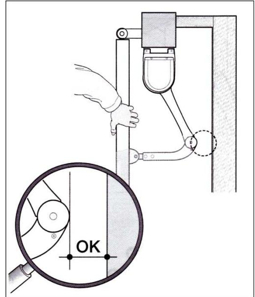
Déverrouiller le motoréducteur, l'amener en position d'ouverture maximum. Faire tourner manuellement la cloche (fig 1) et engager la butée d'arrêt (fig2), faire pivoter de nouveau la cloche pour maintenir la butée en place (fig3). Réaliser la même opération pour la butée d'arrêt de fermeture.
