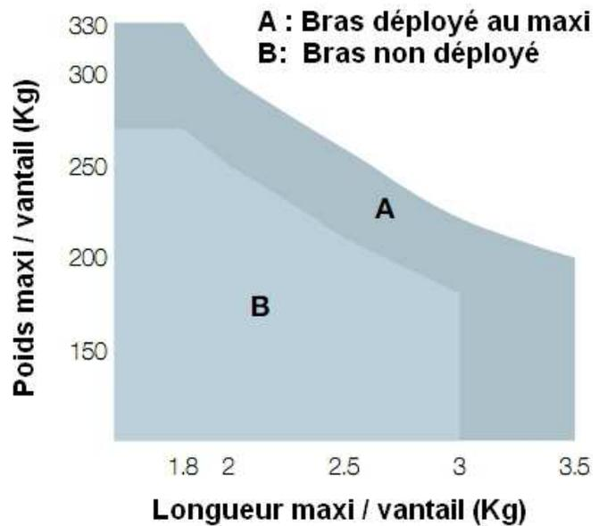
Le Hyke dispose d'un bras articulé autobloquant, pour qu'il soit efficace, il est conseillé d'utiliser l'automatisme que sur des portails posés entre piliers.
