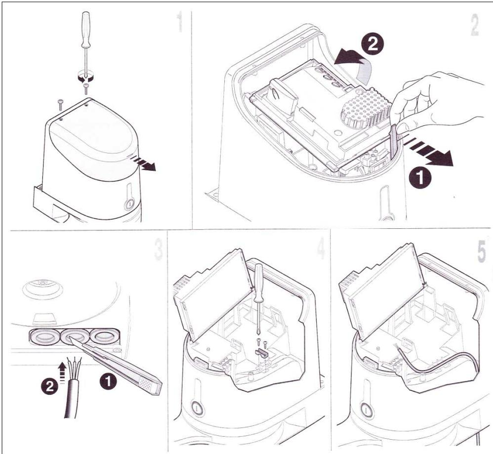
Le NICE Hyke, dispose d'une logique de commande intégrée dans le moteur maître, amener le câble d'alimentation 230volts (fig5).
