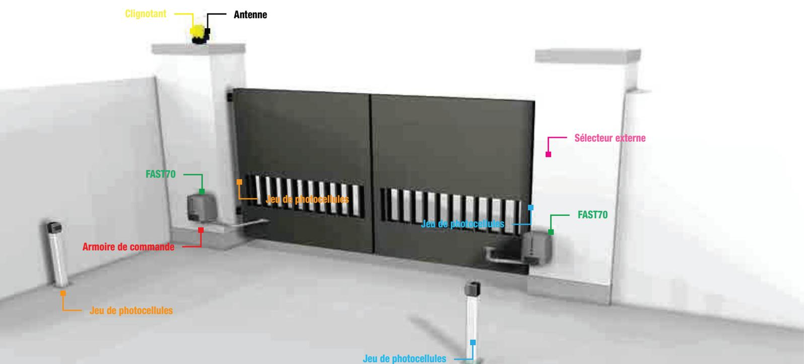
Typologie de câblage - ● 230 V AC ● 2 x 0,5 mm<sup>2</sup> ● 4 x 0,5 mm<sup>2</sup> ● 3 x 1,5 mm<sup>2</sup> ● 3 x 0,5 mm<sup>2</sup> ● 1 x 1,5 mm<sup>2</sup> ● RG58
