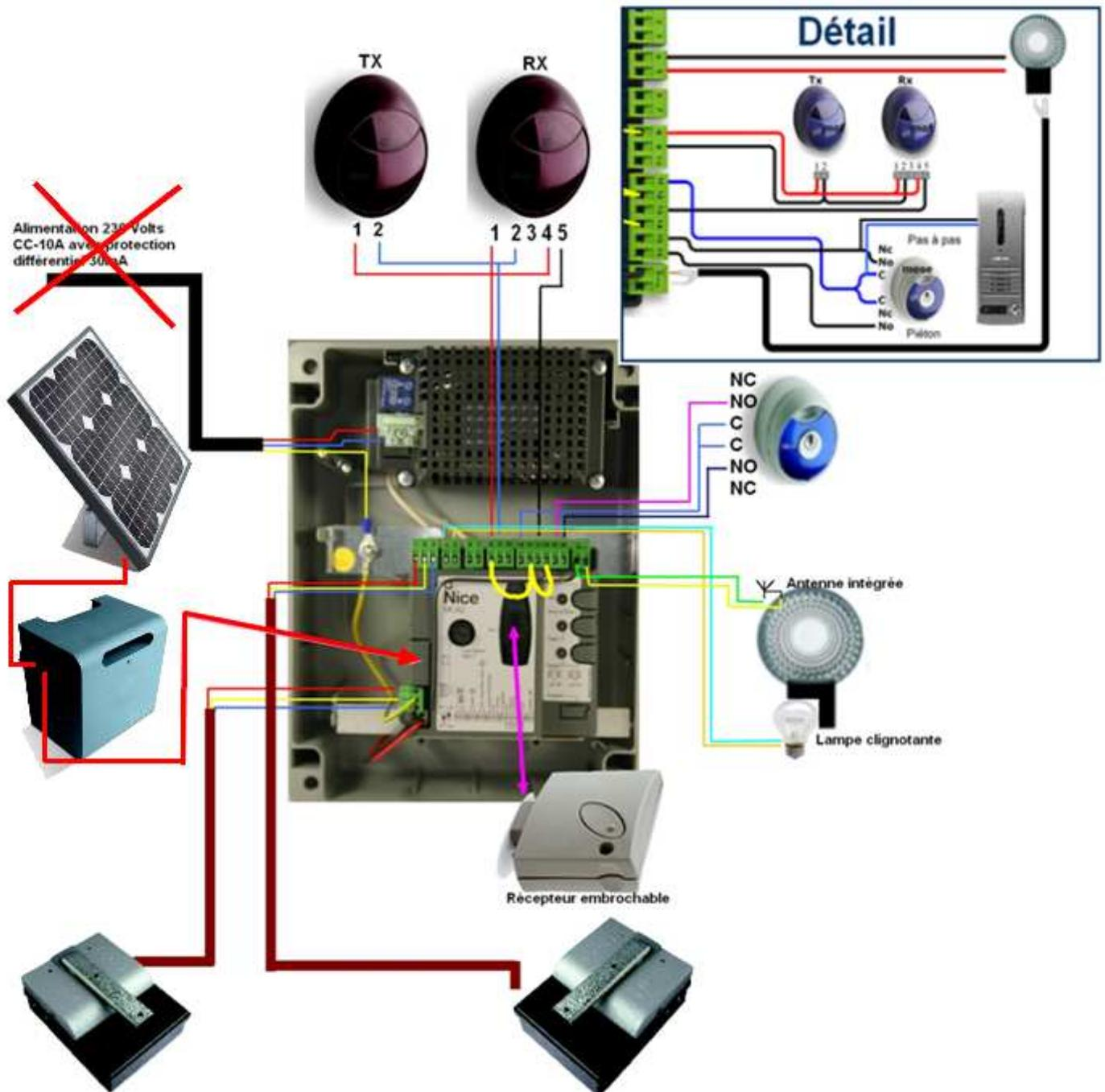
Une fois les connexions raccordées, mettez sous tension, les leds L1 à L5, P1-P2-P3, vont clignoter 5 secondes, ensuite L1-L2-L3, doivent être allumées fixe.
