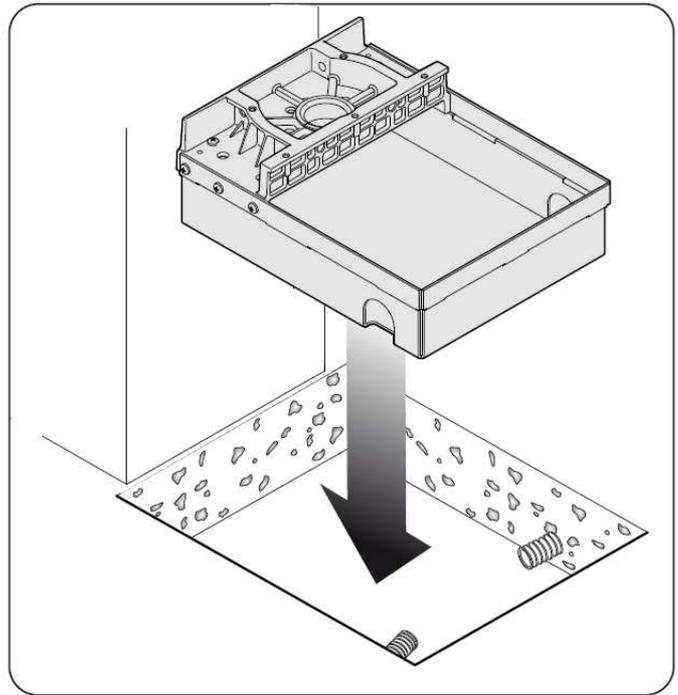
Pour la mise en place des caissons de fondation, réaliser une fouille de 350x400x150mm.
