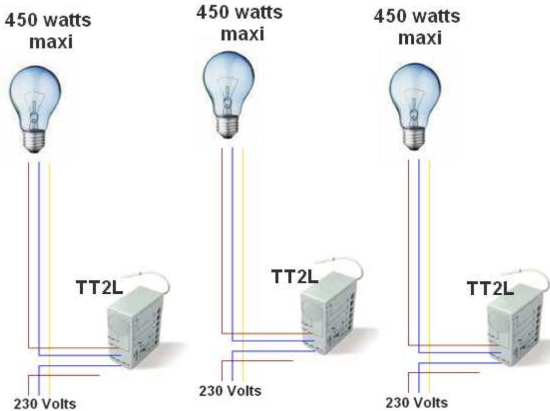
La commande d'allumage se fait par transmission par onde radio vers la logique de commande TT2L
