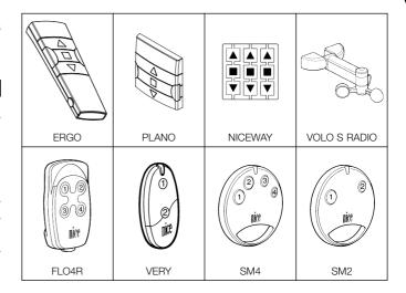
Dans la mesure où les codages des émetteurs sont différents et que la logique ne peut pas les reconnaître simultanément, le premier émetteur mémorisé détermine le type de codage utilisé et donc les émetteurs qui pourront être mémorisés par la suite. Si après la mémorisation du premier émetteur on souhaite changer le type d'émetteurs, il faut effacer tous les émetteurs (tableaux A4).
