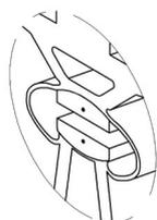
6. Avec un ohmmètre connecté sur le câble du connecteur TCS250, mesurer la valeur de résistance du bord ainsi assemblé; la valeur doit être de  $8200\Omega \pm 500\Omega$ , tandis que quand le bord est actionné, elle doit être inférieure à  $1000\Omega$ . Si ces valeurs de résistance ne sont pas mesurées, il faut enlever les connecteurs et répéter l'opération de montage décrite au point 5.
