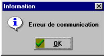
Dans ce cas, essayer une nouvelle fois de créer un nouveau fichier ou contrôler que les câbles de connexion au BUPC sont correctement connectés.
