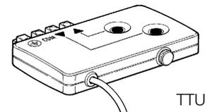
Les phases électriques du moteur "montée" et "descente" sont parfaitement interchangeables dans la mesure où la première fait tourner le moteur dans un sens, la seconde dans l'autre sens. La montée et la descente dépendent du côté par lequel est inséré le moteur dans l'axe du volet roulant ou du store. Pour modifier le sens de rotation, inverser les conducteurs brun et noir.
